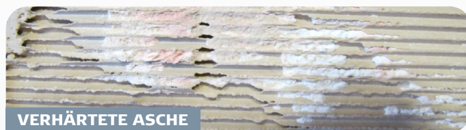
Querschnitt eines Filters nach einer 2-stufigen Reinigung. Die weißen Rückstände bleiben erhalten und blockieren weiterhin teilweise den Abgasstrom.
